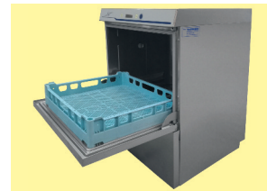
Geschirrpülmaschine, gewerbl., Wechselkorb-Version, 3 Programme/Professional dishwasher, interchangeable basket-system, 3 programs 230 V, 3,2 kW oder 400 V, 7,5 kW 60 x 82 x 60 cm
